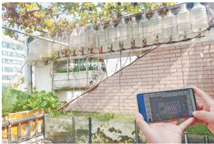
崔俊杰研究自创的智能滴灌器可通过操控手机APP来实现自动给蔬菜浇水或自动给储水桶加水。
