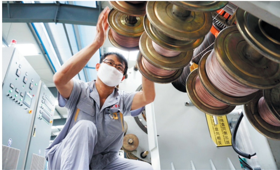
方大新材料公司工作人员正在钢丝网骨架复合管生产线更换钢丝分盘。
