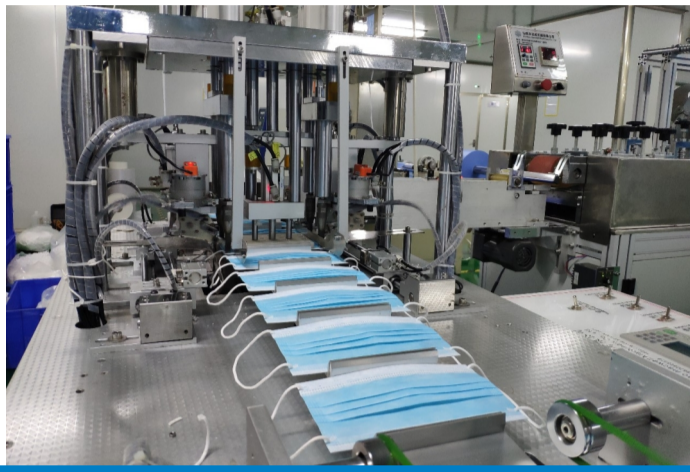
公司生产车间用于口罩生产的制片机、自动点焊机一刻不停地运转。
