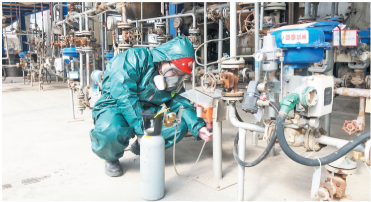
淄博市计量测试所工作人员在进行安全防护类报警器检测。
