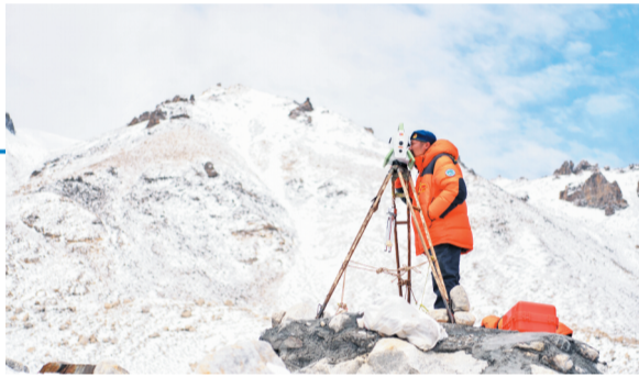
自然资源部第一大地测量队队员郑林在使用全站仪对珠峰峰顶进行交会观测。新华社发
