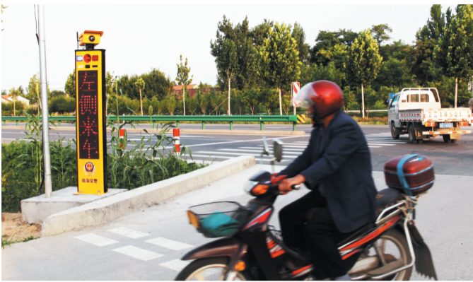
道路让行安全警示系统。
