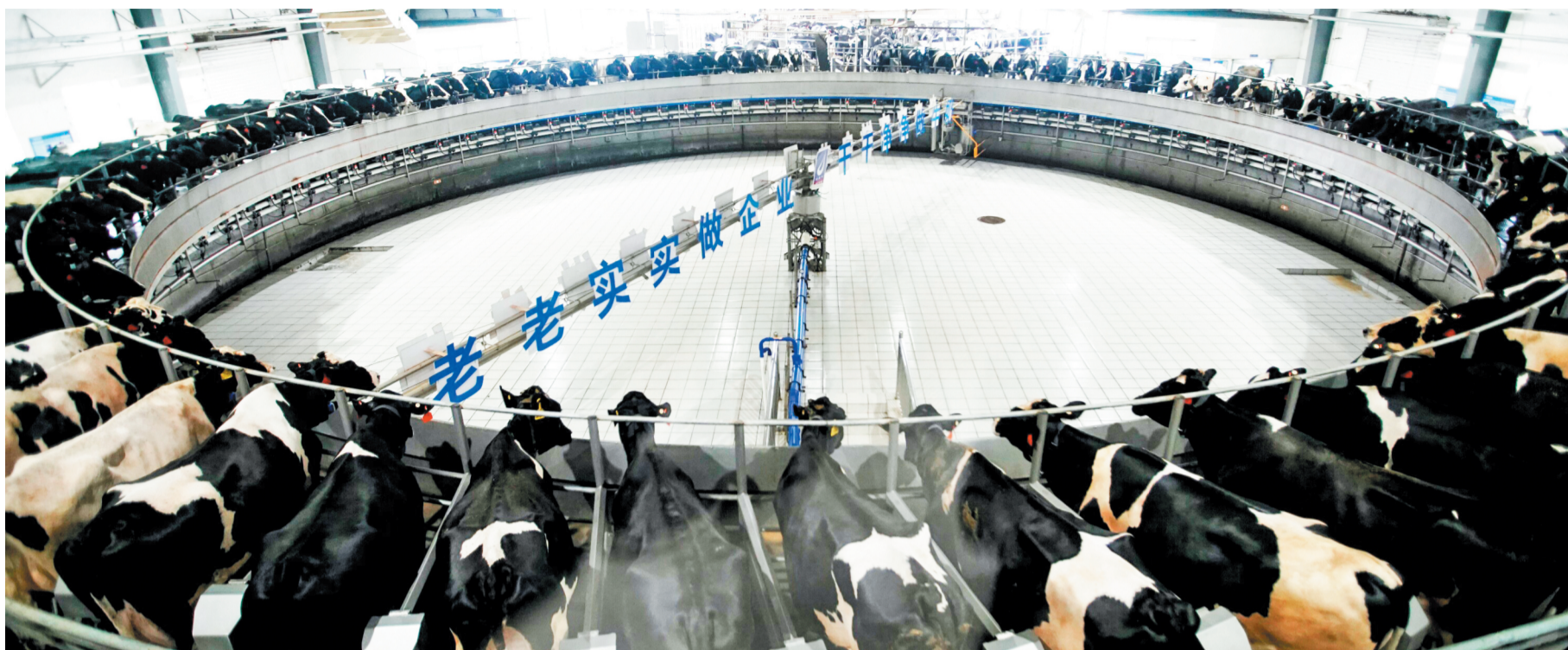
8月26日上午,位于高青县的山东得益乳业股份有限公司第二牧场挤奶大厅中,奶牛正在瑞典利拉伐80位重型转盘挤奶机上排队挤奶。
