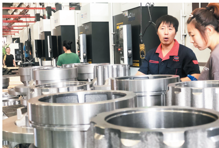
山东宏马工程机械有限公司铸造车间里，工人正在打磨轮毂。
