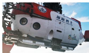
我国第二代载人潜水器——4500米型的“深海勇士”号完成全部海上试验任务,随后投入使用,国产自主率超过95%,实用性更强。
