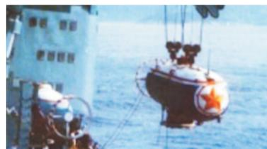
中国第一艘载人潜水器——7103救生艇研制成功。虽然它只能下潜300米,航速也只有四节,但也是那个年代最先进的救援型载人潜水器。
