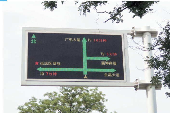
柳泉路与新村路路口南侧安装交通诱导屏,实时显示交通情况。
