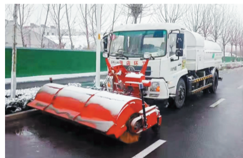
张店区市容环卫事业服务中心使用雪滚车清理路面积雪、积水。
