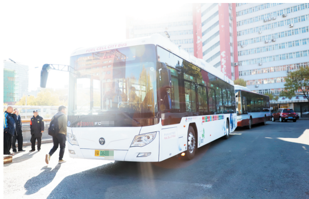
这些公交车搭载了由北京亿华通科技股份有限公司生产的氢燃料电池发动机。 资料照片
