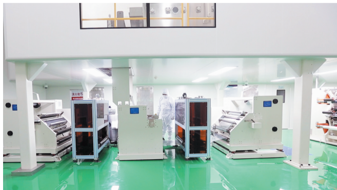
这是东岳集团的质子交换膜生产现场。氢燃料电池质子交换膜被誉为“氢燃料电池汽车芯片”。 资料照片
