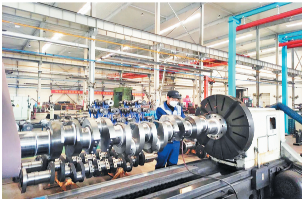
淄柴公司生产现场,工人进行曲轴抛光。 资料照片
