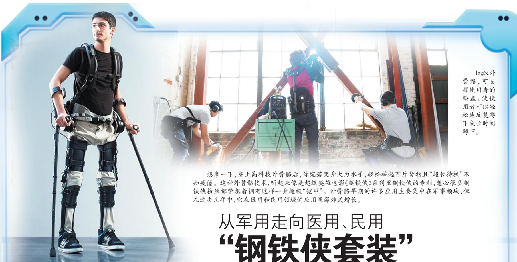
legX外骨骼，可支撑使用者的膝盖，使使用者可以轻松反复蹲下或长时间蹲下。
