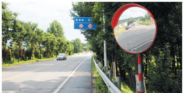
在县乡道路转弯处,增设道路反光镜等交通设施。
