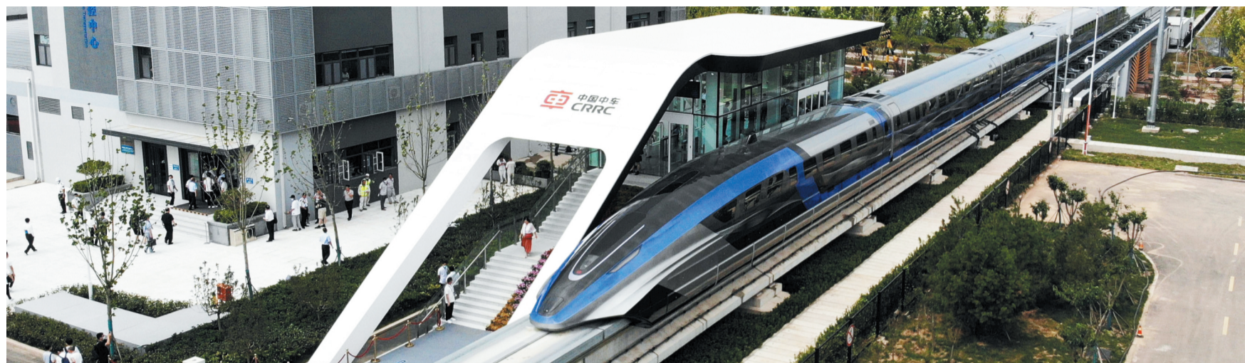
7月20日在山东青岛拍摄的时速600公里高速磁浮交通系统(无人机照片)。 新华社发
