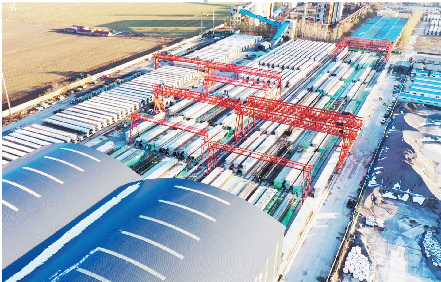
11月9日,鲁泰大道项目三分部梁场存放区内,一片片已完工的预制箱梁排列得整整齐齐。
