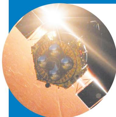
国家航天局提供的“天问一号”在轨工作效果图。目前，“天问一号”环绕器运行在一个椭圆轨道上，大概是8小时绕火星一圈，最近的地方距离火星表面400公里，最远的地方距离火星表面1万公里。
