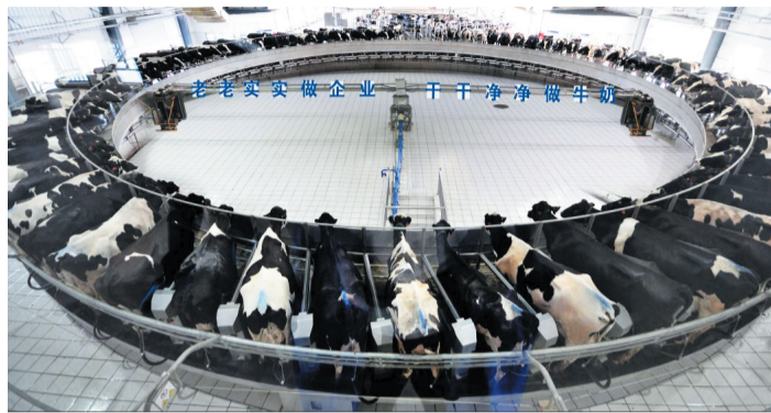
得益乳业第二牧场引进的高效率、数字化瑞典利拉伐80位转盘重型挤奶机。
