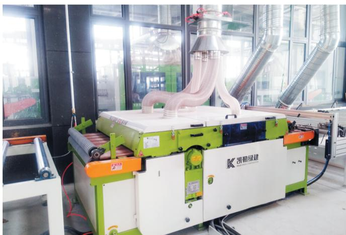
在凯勒蓝房的生产车间内，生物质无机饰面板被自动切割后，产生的粉尘通过负压系统收集起来，在原料生产环节可以循环利用。
