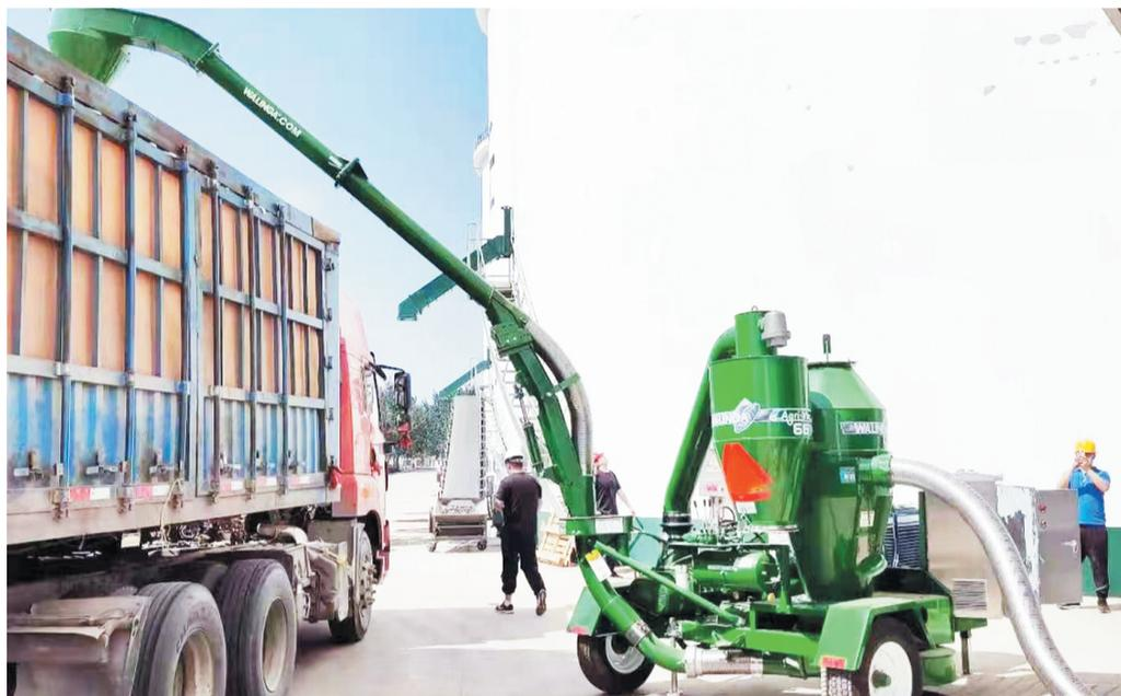
工人使用全自动吸粮机进行粮食无尘出入仓作业。
