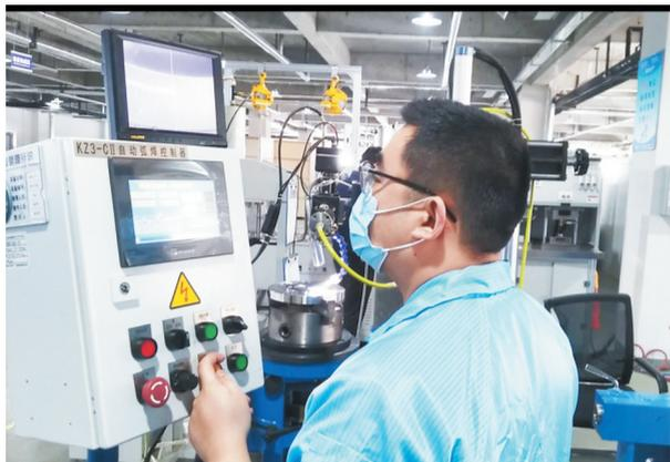
焊接工序上的工人正在操作自动弧焊机。
