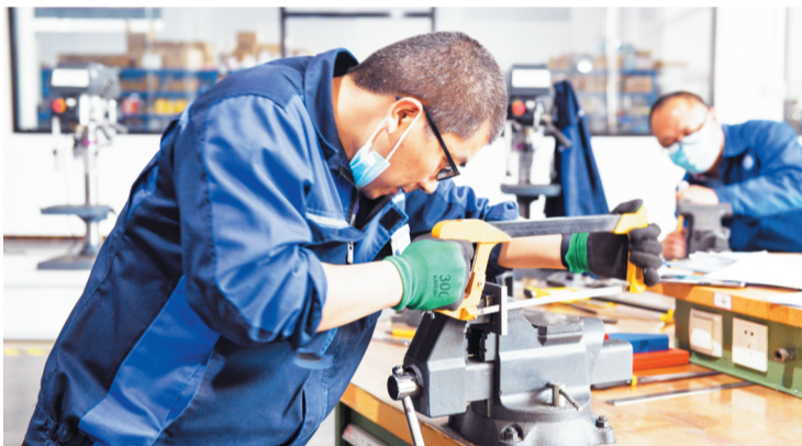
钳工实际操作考试现场,考生使用钢锯分割铁块。
