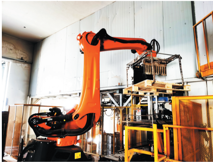
车间里用于货物搬运的码垛机器人
