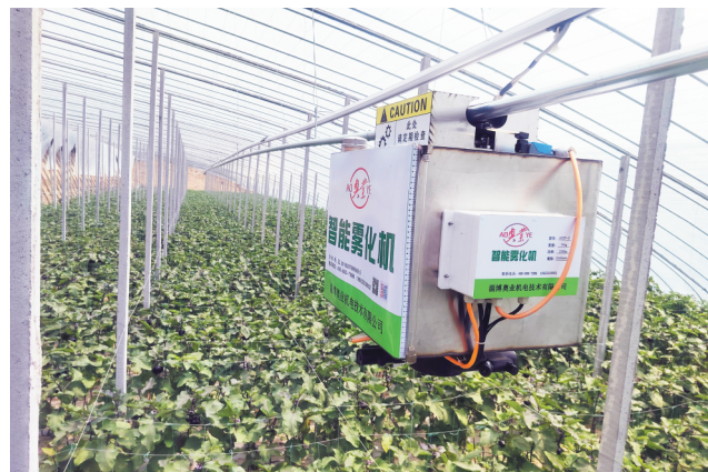
蔬菜大棚里,一台自走式风送雾化喷施机沿着离地三米悬挂的轨道作业。
