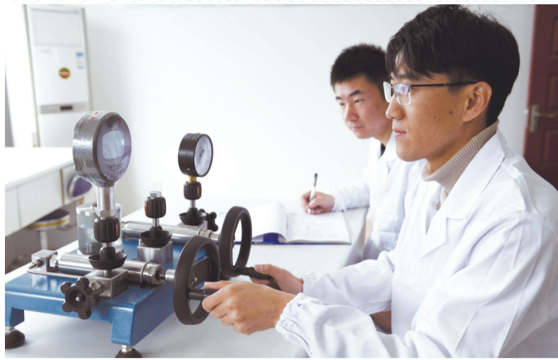
盛安建设集团有限公司工作人员正在进行压力表检定。
