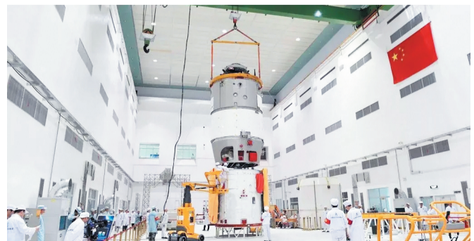
神舟系列飞船都涂上了“太空防晒霜”——低吸收-低发射型热控涂层。
