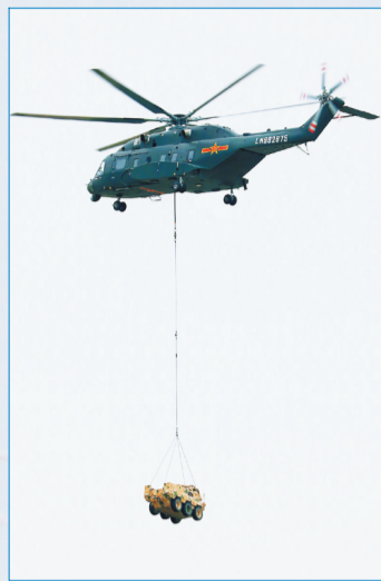
直-8L运输直升机吊装轮式作战车辆。
