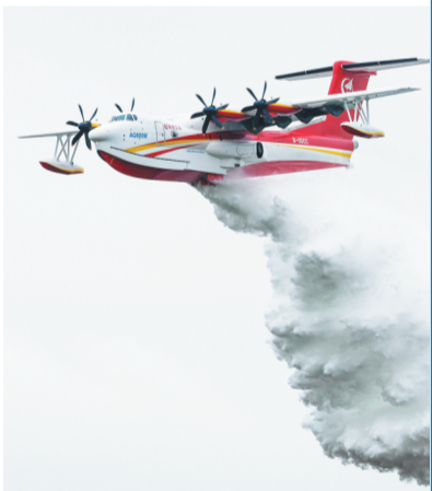
国产大型灭火/水上救援水陆两栖飞机AG600M进行飞行投水演示。
