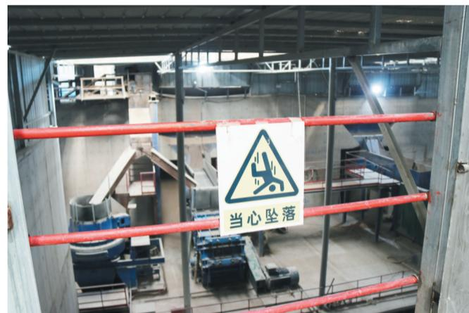
大型破碎设备置于地下约10米处，有效减少噪声向外传输。
