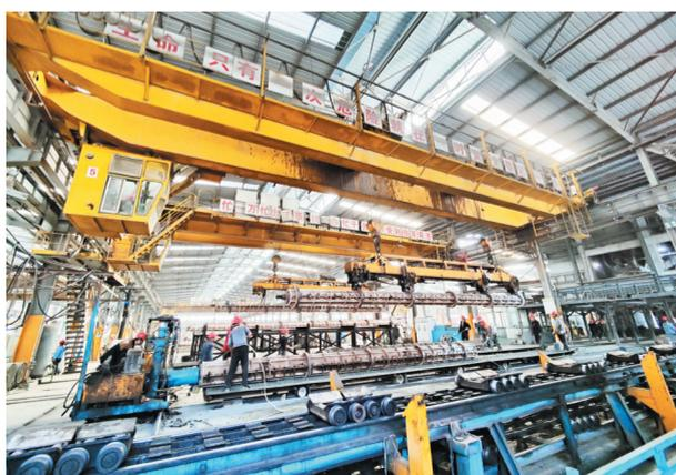
车间内,预制混凝土方桩和管桩等产品正在生产中。
