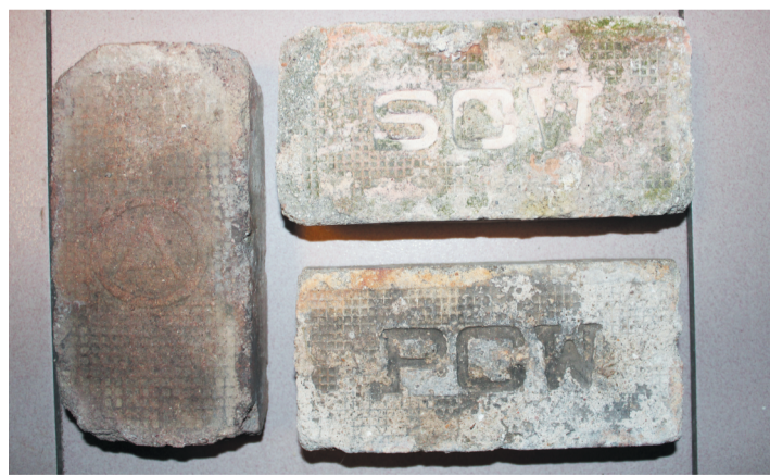
耐火砖的正面除了网纹图案,还有“SCW”“PCW”“A”等英文标识。
