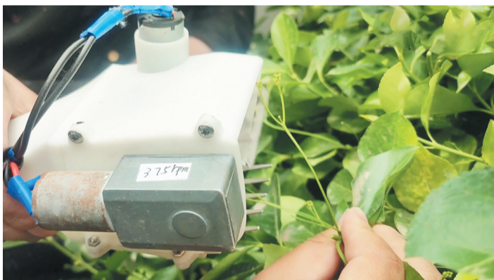
形似吸尘器的花椒采摘机,将极大提高花椒采摘效率。
