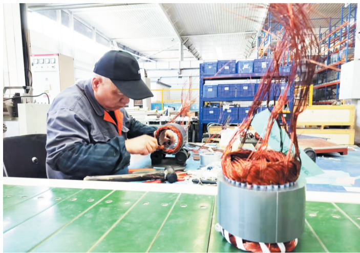
得普达电机车间工人正手工绕线生产电机定子。
