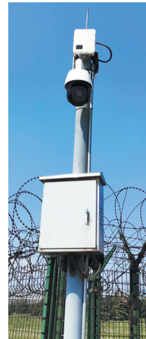
安装在机场边界用于防止人员侵入的安防雷达。
