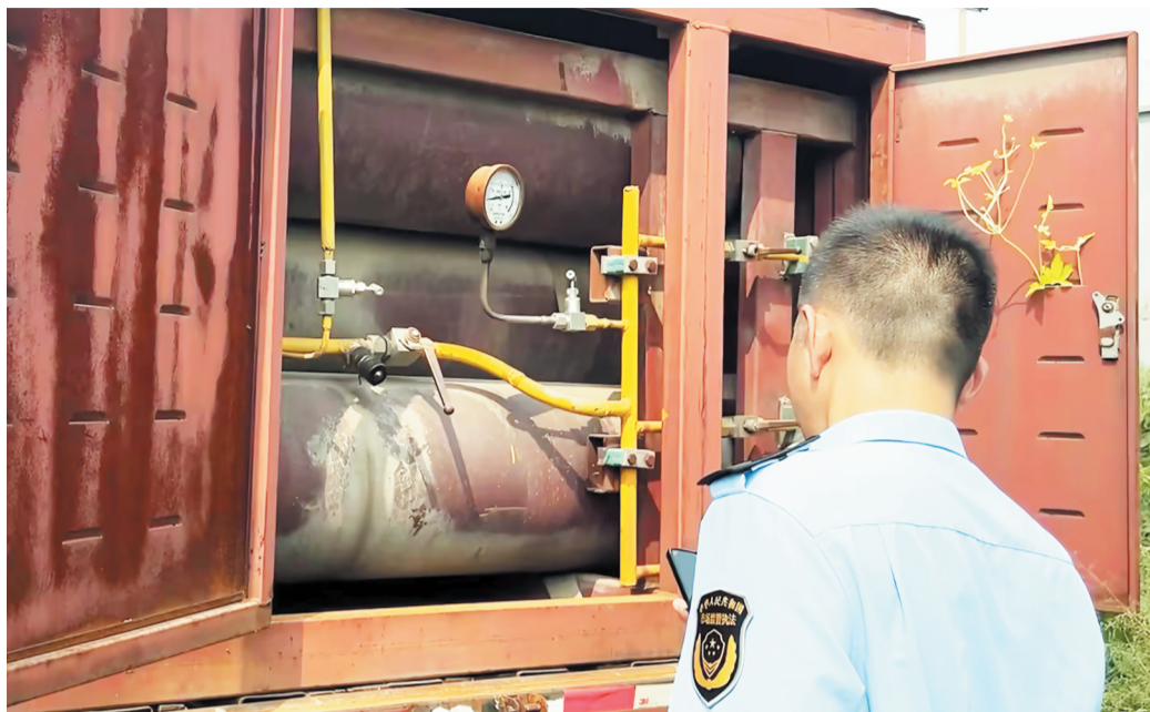
查验过程中,执法人员在一辆货车内发现管束式气瓶集束装置,该车疑似压缩天然气瓶组运输车辆。
