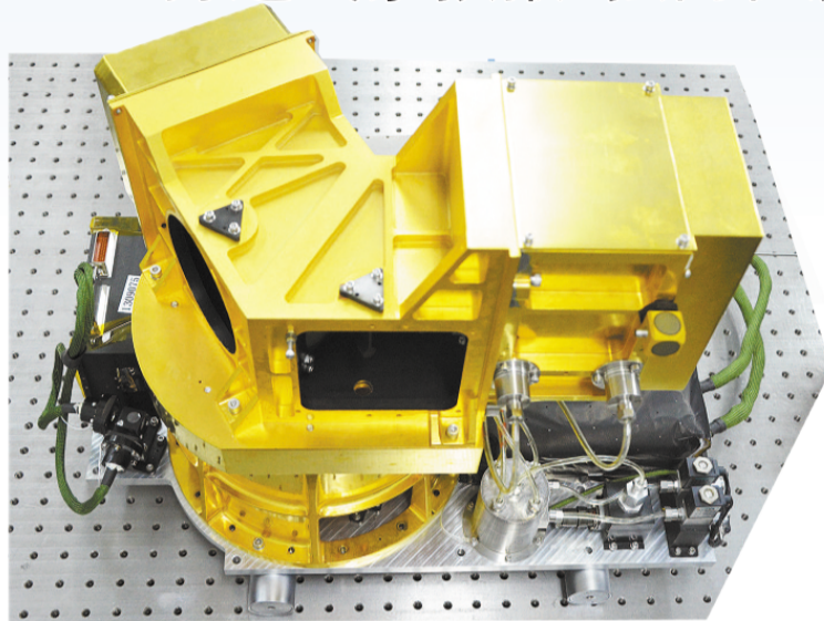
干涉式大气垂直探测仪核心——低温红外干涉仪。
