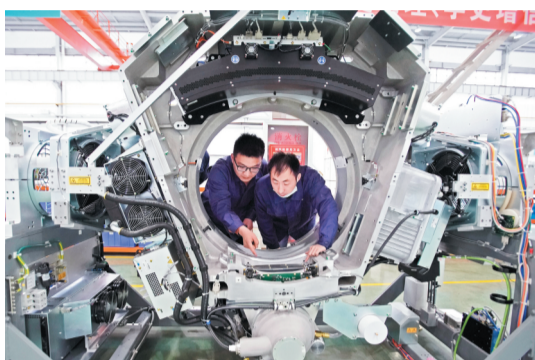
员工正在组装调试大孔径CT。
