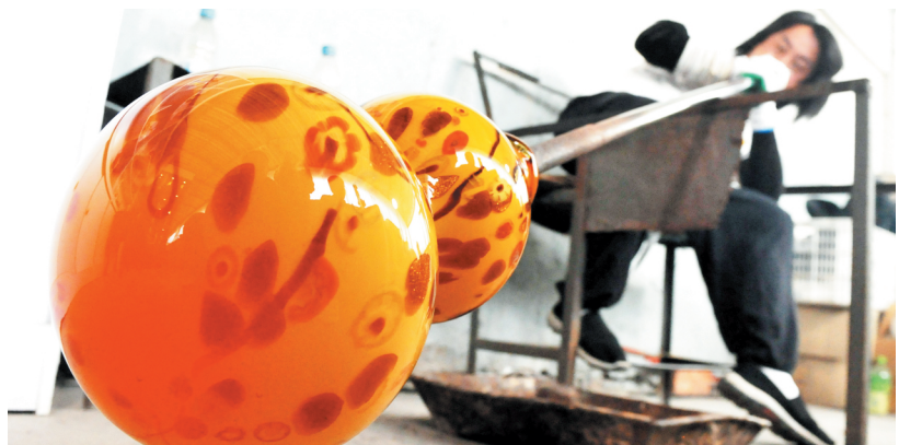
琉璃制作过程中需要人工吹制，将葫芦等器型定型。通过两米多长的空心铁杆吹气，对肺活量要求极高。
