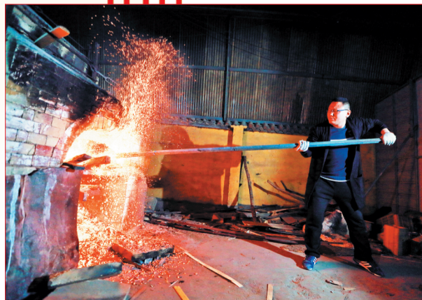
在1954文创园内,昆仑陶瓷艺人正在用传统的柴烧工艺烧制陶瓷。
