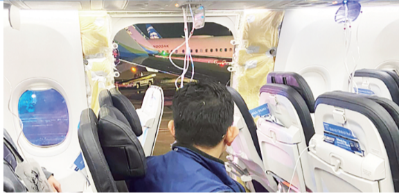
1月5日,美国阿拉斯加航空一架737MAX9飞机在起飞后不久,左侧中后部应急舱门脱离机身。
