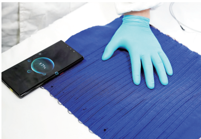
4月22日，复旦大学的研究人员展示手机可放在编织有纤维电池的织物上充电。新华社发
