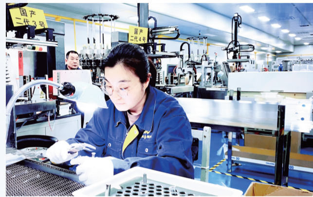
民康药业生产车间，工人正在对注射器玻璃外套进行质检。
