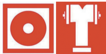
消防手动启动器 消防水泵接合器
