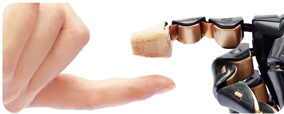
装有仿生三维电子皮肤的机械手与人手互动。
